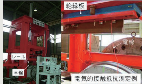
車輪/レール接触部の抵抗測定試験
